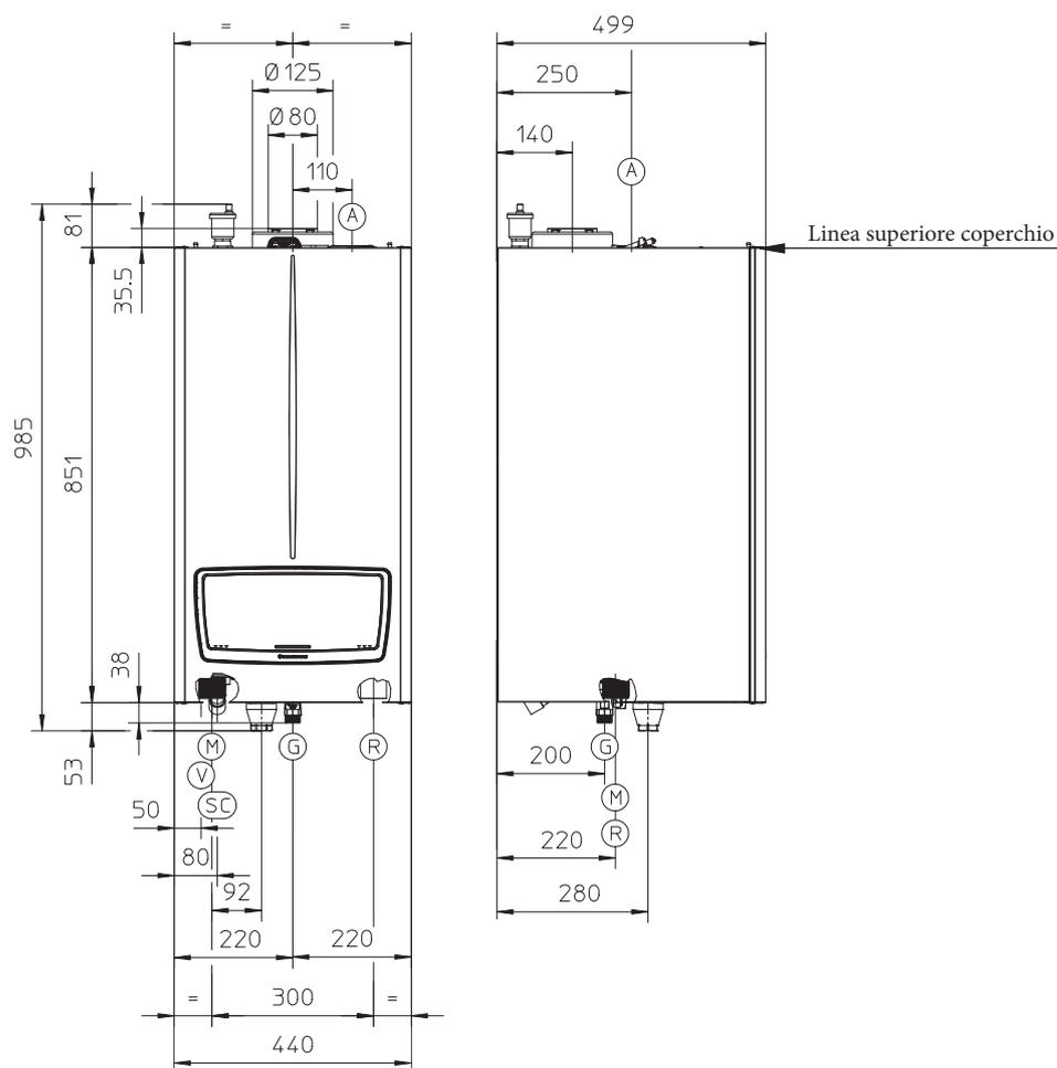
SC = Scarico condensa Ø 25 mm
